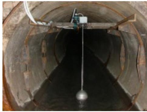
Поплавковый уровнемер ЛЕВЕЛ предназначен для измерения уровня жидкостей в открытых и закрытых резервуарах, безнапорных каналах и стоках.
